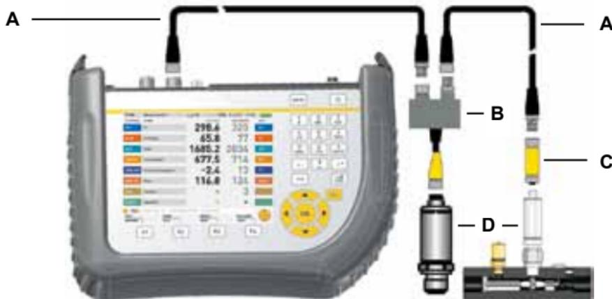
Conexión de varios sensores CAN
