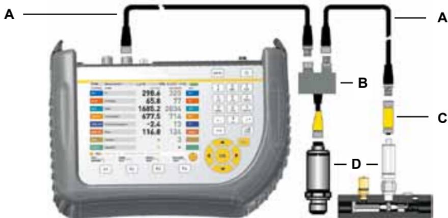
Anschluss von mehreren CAN-Sensoren
