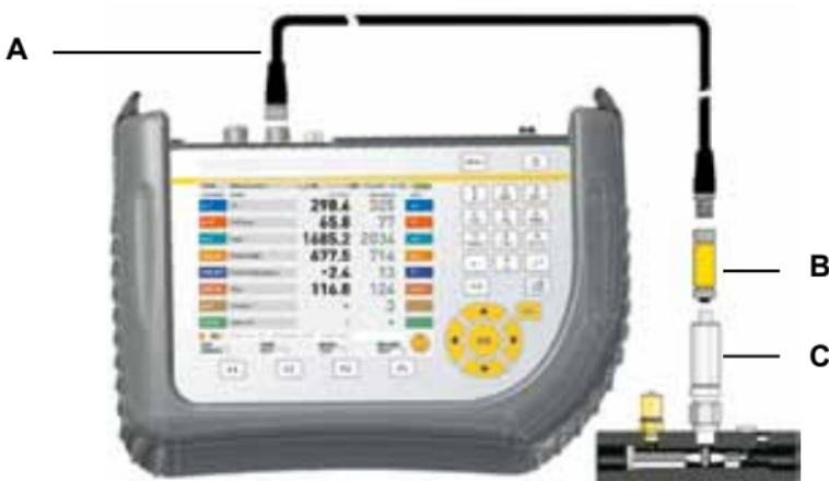
Conexión de un sensor CAN
