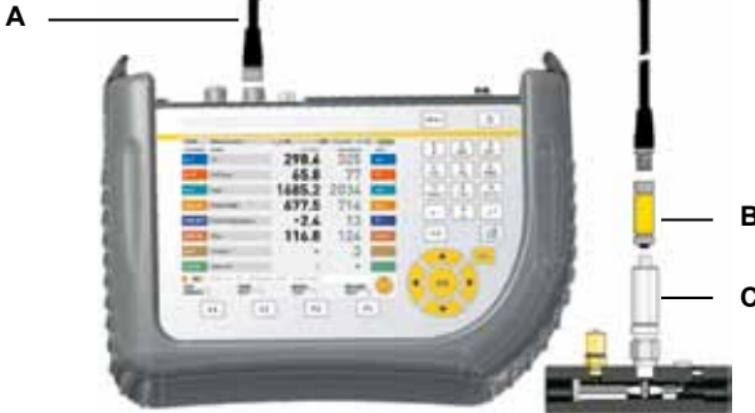
Collegamento di un sensore CAN
