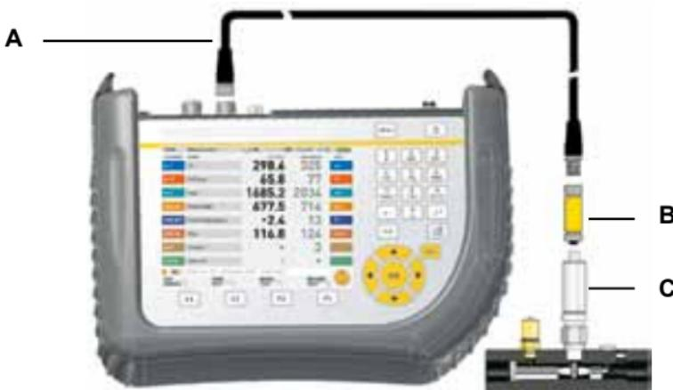
Anschluss von einem CAN-Sensor
