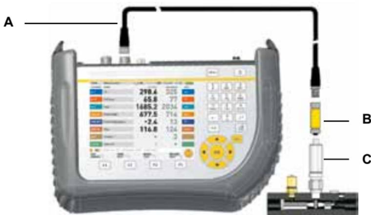
Raccordement d'un capteur CAN
